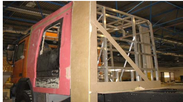
Træopbygning, som anvendes til udformning af støbeformen.
